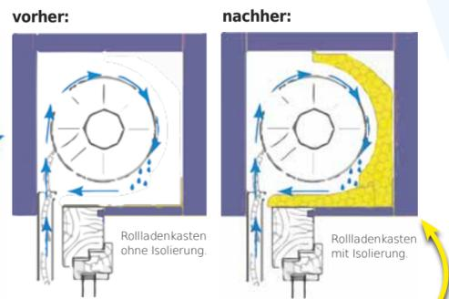
Bei alten, ungedämmten Rollladenkästen dringt von außen stetig kalte Luft in den Wohnraum, Wärme entweicht und lästige Straßengeräusche stören.
